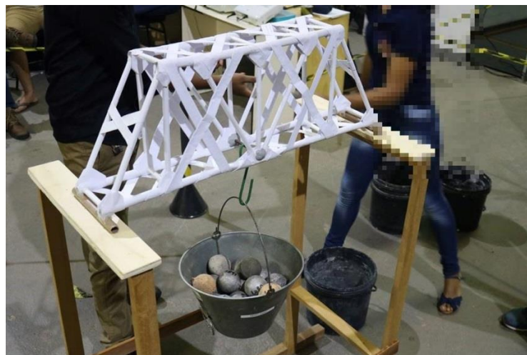
Figura 10: Pesagem da carga durante o rompimento da ponte de papel.
